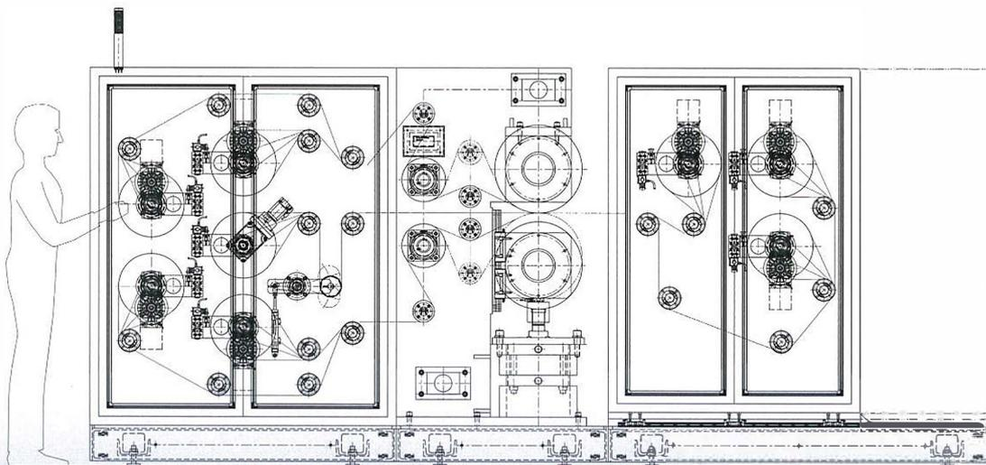
装置寸法 幅2200mm × 高さ2100mm × 全長4200mm
